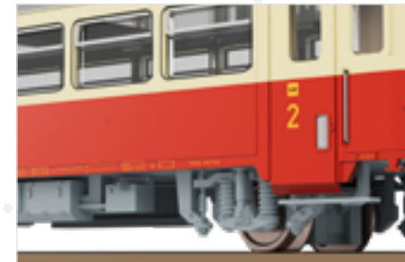
Angesetzte Griffstangen neben den Türen
