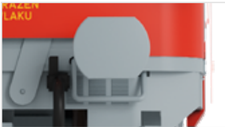
Separat angesetzte Griffe unter den Puffern
