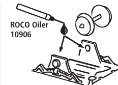
Ca. alle 30 Betriebsstunden! • I.e. after it has been in operation for 30 hours! • Environ tous les 30 heures d'exploitation! • Na elke 30 diuren!
